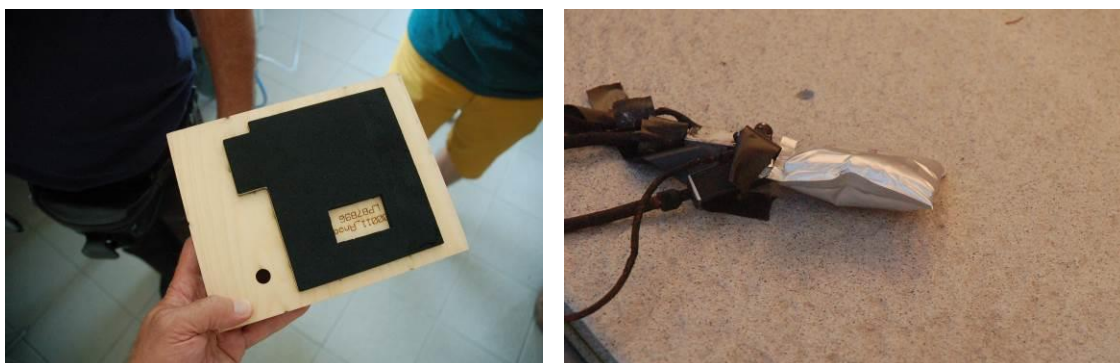
Lítium-ion akkumulátor és túltöltési teszt
